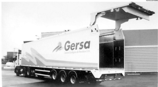
UNO DE LOS GRANDES CAMIONES, CON LA PUERTA HIDRÁULICA ABIERTA PARA RECIBIR LAS 23 TONELADAS DE DESECHOS QUE ES CAPAZ DE CARGAR.
